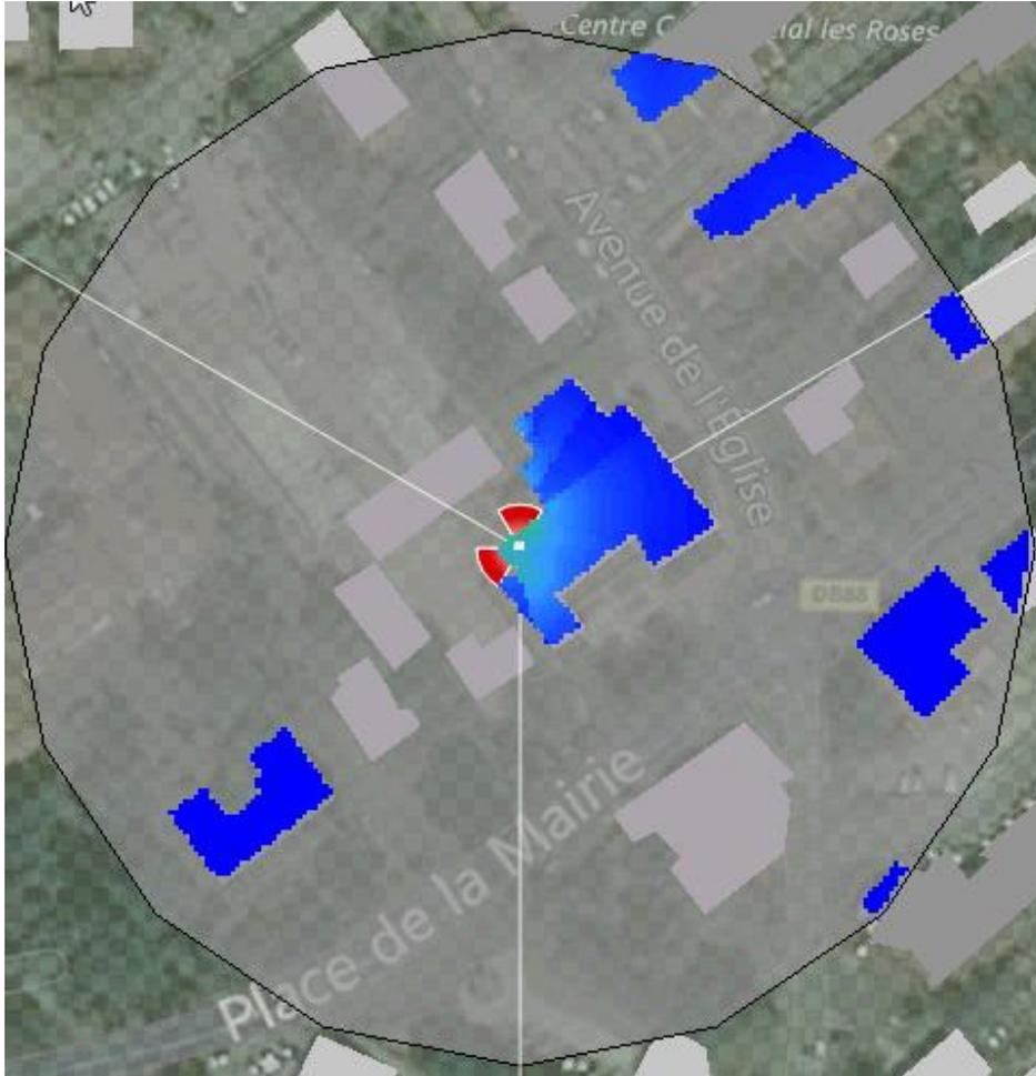
Pour l'antenne orientée dans l'azimut 0°, le niveau maximale simulé est compris entre **1 et 2 V/m** et se situe à une hauteur de 4,50 m par rapport au sol.
